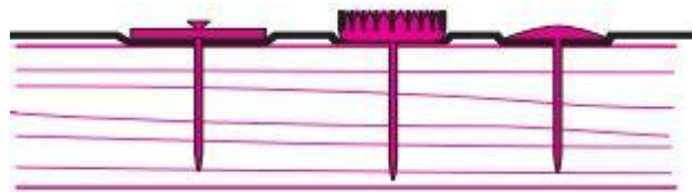
Figura B-01: Sujeción del plástico mediante rodela o tachuelas
