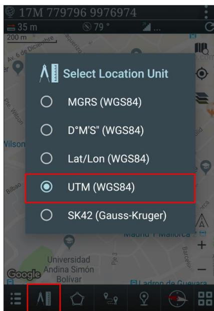
Figura 11. Configuración de la herramienta en sistema de coordenadas UTM
